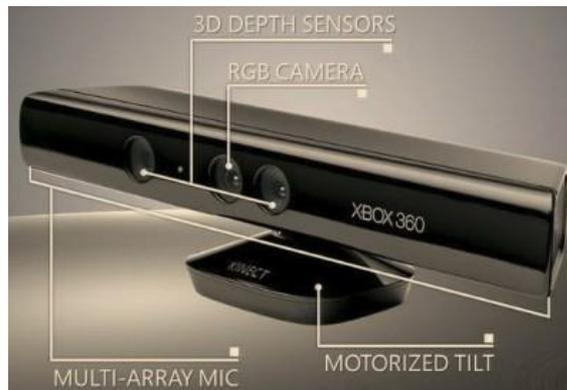
Figura 1.10.- Componentes de la Kinect
