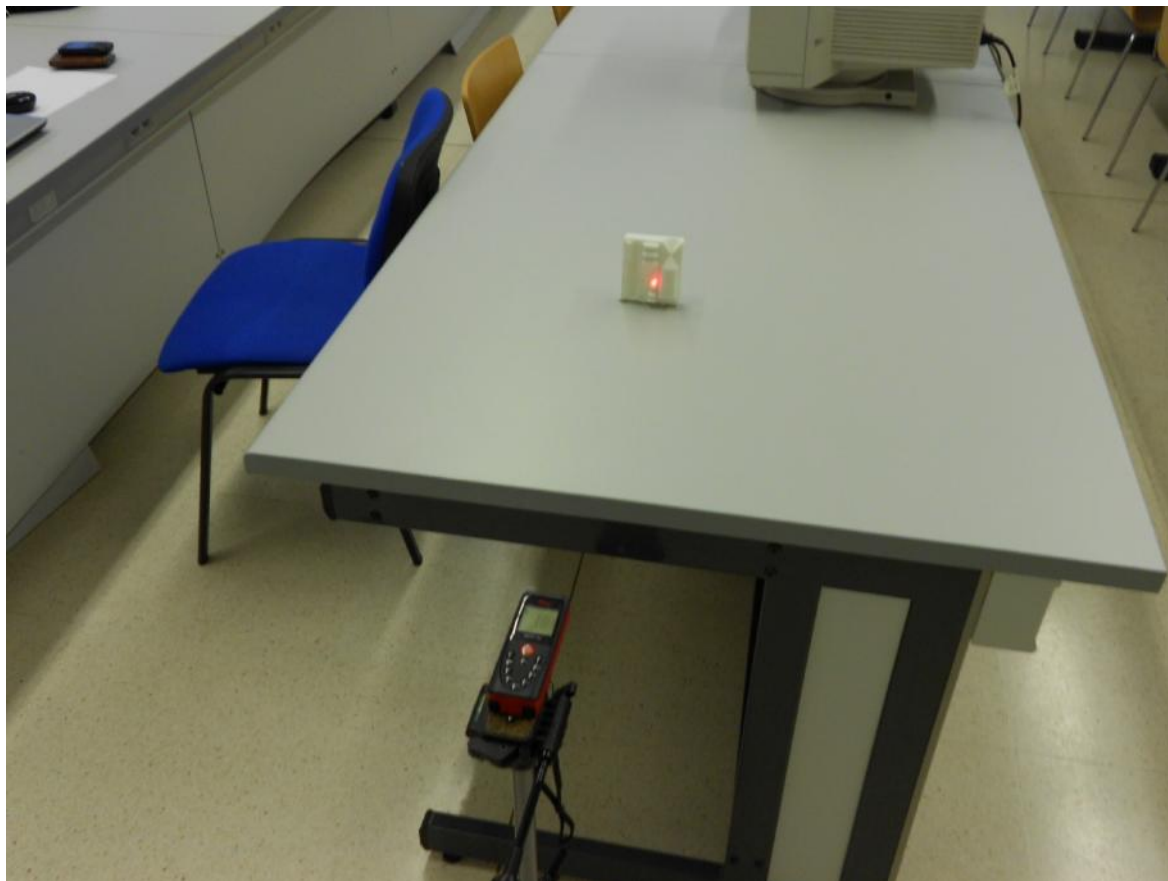
Figura 4.2: Mediciones con láser.
