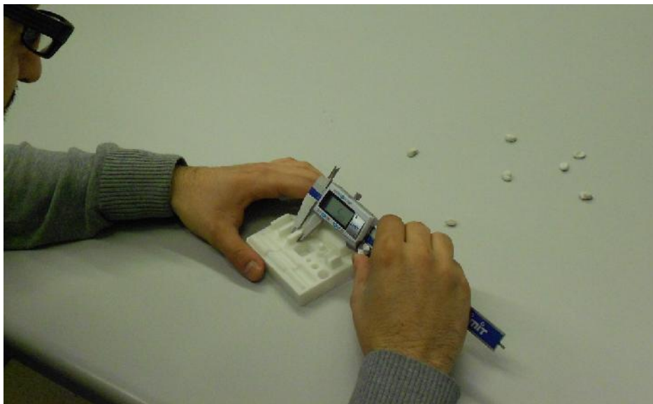
Figura 4.1: Medición de la pieza con calibre.
