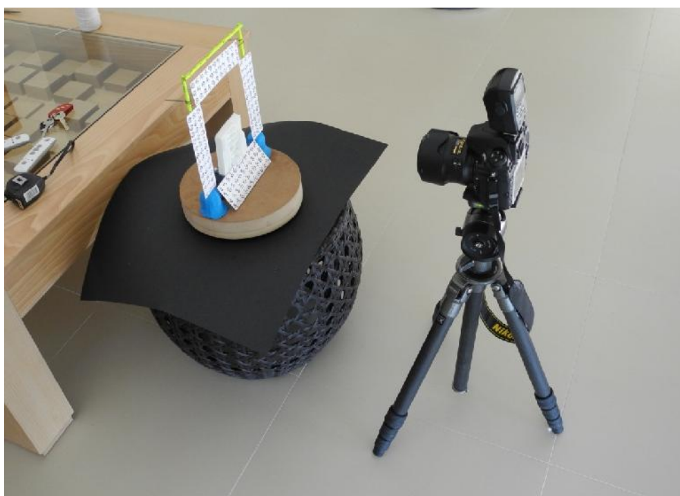
Figura 3.46: Colocación de pieza, torno, cámara y trípode.
