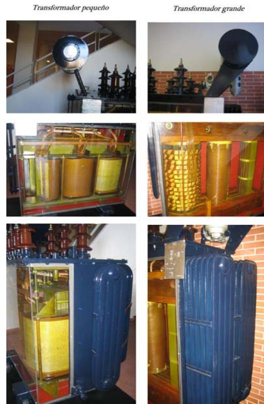
**Figura 2.2.6-10:** Diferencias entre transformadores
