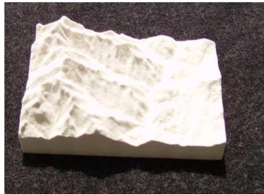
Fig. 10. Terreno 1 antes de la impregnación con la resina.
