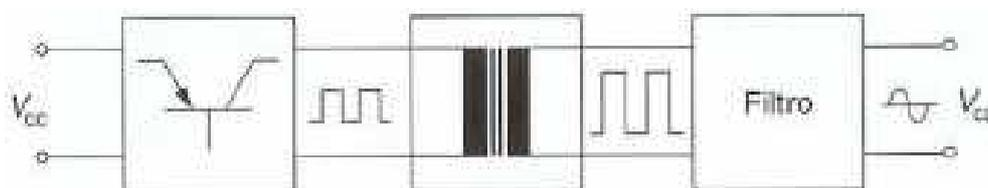
**Figura 32:** Esquema de bloques de un inversor CC/CA
