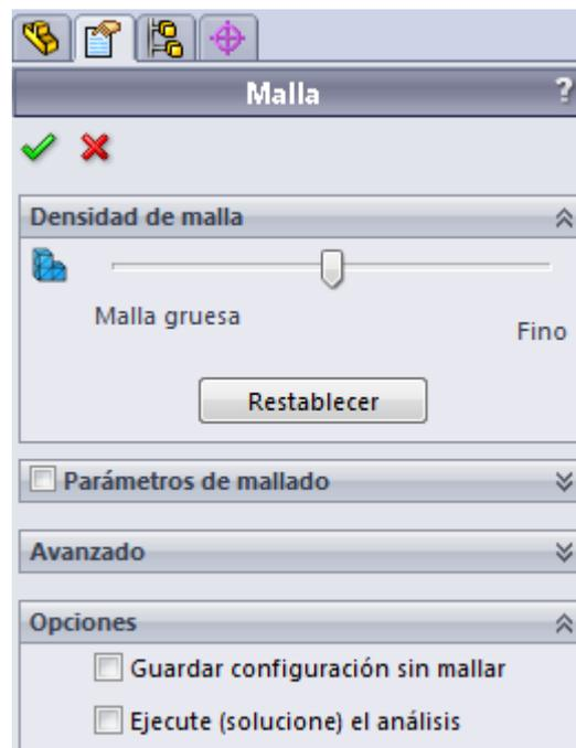
El dato definitivo de optimización de mallado ha sido extraído tras una serie de pruebas ensayo/error con la condición de obtener el punto óptimo entre precisión en los resultados obtenidos y el requerimiento de recursos técnicos requeridos al PC. He realizado varios mallados aumentando la precisión del mallado hasta obtener unos resultados cuya tolerancia en relación a los recursos informáticos consumidos eran
