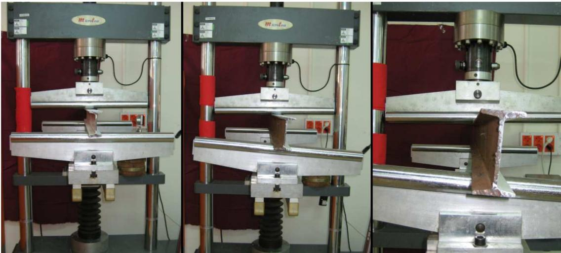
**Figura 13.** Efecto de torsión y oscilación de los apoyos en el perfil IPN 100.
