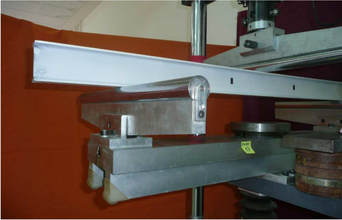
La máquina electromecánica se programó para un fin de rampa preestablecido de acuerdo con el número de imágenes a tomar por ensayo. Se programó una velocidad de aplicación de la carga de 50 N/s y en cada parada se dispara cámara por cámara.
