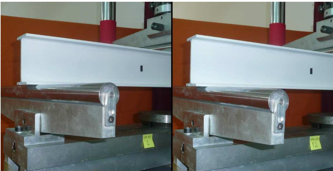
**Figura 15.** Efecto de oscilación de apoyos en el perfil IPN 120.
